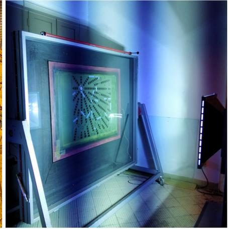
Durch das Belichten mit ultraviolettem Licht wird die Kopierschicht, auf die das Licht trifft, wasser- und lösemittelfest. Die Zeichnung auf der Folie verhindert eine Belichtung der Kopierschicht an den dahinter liegenden Stellen. Diese nicht belichteten Bereiche sind weiter-
