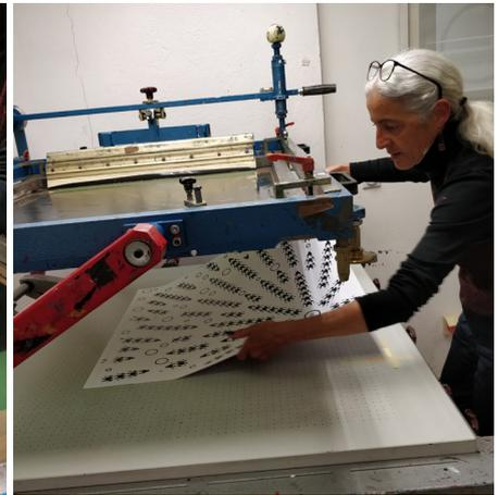
Die zum Drucken verwendete Rakel muss links und rechts 3-4 cm breiter sein als das Motiv im Sieb. Man braucht reichlich Farbe auf dem Sieb. Das zu bedruckende Papier liegt unter dem Sieb. Zuerst wird das Sieb geflutet, das heißt, die Farbe wird mit der Rakel ohne Druck über das Sieb verteilt. Zum Drucken wird die Rakel etwa 2-3 cm oberhalb des Druckbildes aufgesetzt und die Farbe dann langsam und gleichmäßig, ohne zu stocken durch die offenen Maschen
