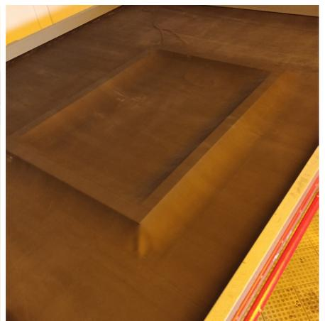
Wenn die Kopierschicht getrocknet ist, kann man die Druckschablone, das Druckbild im Sieb, erstellen. Die Druckvorlagen werden seitenrichtig mittig auf der Glasplatte des Vakuumkopierrahmens platziert. Das zu belichtende Sieb wird auf die Druckvorlage gelegt. Dabei muss auf einen ausreichenden Abstand zwischen dem Druckbild- und dem Siebrand geachtet werden (ca. 15 cm). Nach dem
