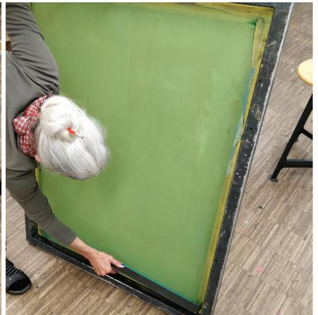
Die Siebgewebe werden mit einer Schichtrinne von beiden Seiten mit der lichtempfindlichen Kopierschicht beschichtet. Angefangen wird auf der Druckseite. Das ist die Seite des Siebes, auf der das Gewebe auf den Aluminiumrahmen aufgeklebt ist, die, mit der es beim Drucken nach unten im Drucktisch liegt.
