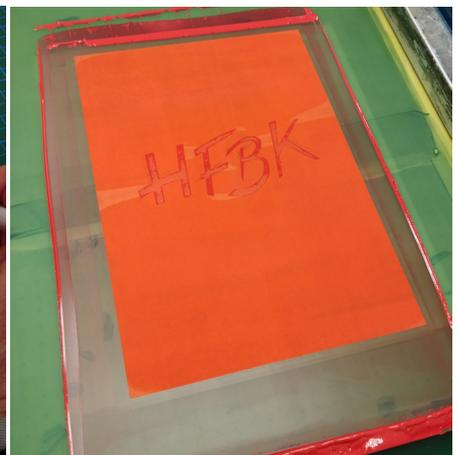
Eine Möglichkeit, ohne ein belichtetes Sieb zu drucken, ist mit Papiermasken gegeben. Dafür werden die Stellen, die drucken sollen, aus einem dünnen Papier geschnitten oder gerissen. Diese Maske
