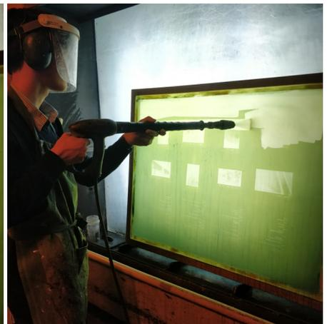
Zum Entfernen der Druckschablone werden beide Seiten des Siebwebes mit der Entschichterchemikalie besprüht, die dann mit einem dicken, lösemittelbeständigem Pinsel eingerieben wird. Wenn die Kopierschicht anfängt, sich aufzulösen, wird das Gewebe von beiden Seiten mit maximal erhöhtem Wasserdruck (Kärcher ein-
