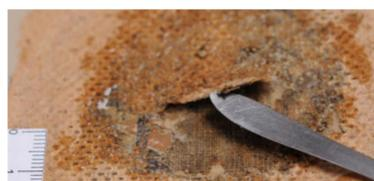
Abnahme der Hartfaserplatte durch Anquellen des PVAc-Leims mit wässrigem Gel.
