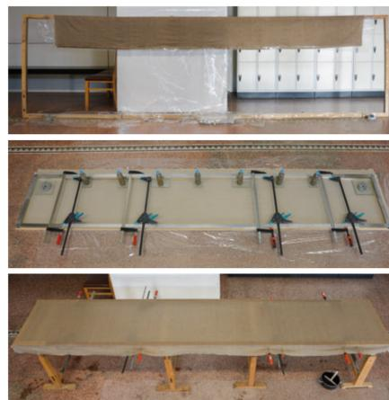
Waschen, fadengerades Aufspannen und Dekatieren des Stabilisierungsgewebes
