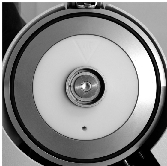
Abb. 35: Blick auf die Ofenzelle mit keramischer Umgebung und Aluminiumform mit DSC-Aluminiumdeckel (untere Bildkante entspricht 15 cm).
