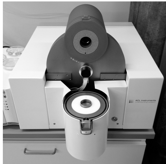
Abb. 28: Ansicht des CL-Prototyps mit Ofen und Detektor sowie den Steuergeräten.
