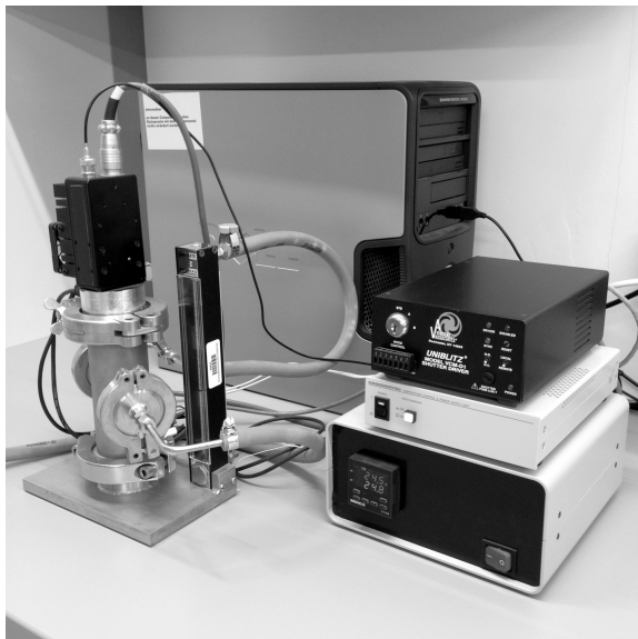
Abb. 28: Ansicht des CL-Prototyps mit Ofen und Detektor sowie den Steuergeräten.
