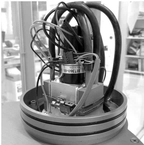
Abb. 31: Ansicht auf den Photomultiplier von Hamamatsu Corporation mit Umwälzkühlung.
