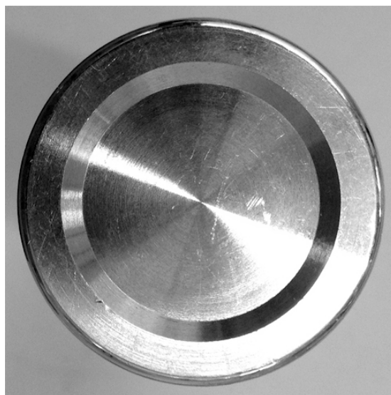
Abb. 35: Blick auf die Ofenzelle mit keramischer Umgebung und Aluminiumform mit DSC-Aluminiumdeckel (untere Bildkante entspricht 15 cm).
