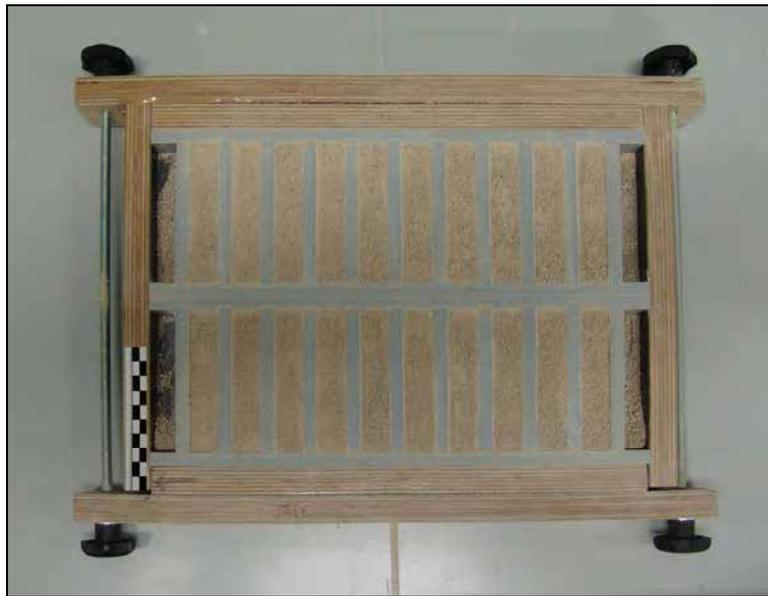
Abb.06: Form aus Kunststoff und Multiplex für die Herstellung von Mörtelprismen, nach Vorgabe von T. Köberle in der Tischlerei der HfBK Dresden hergestellt
