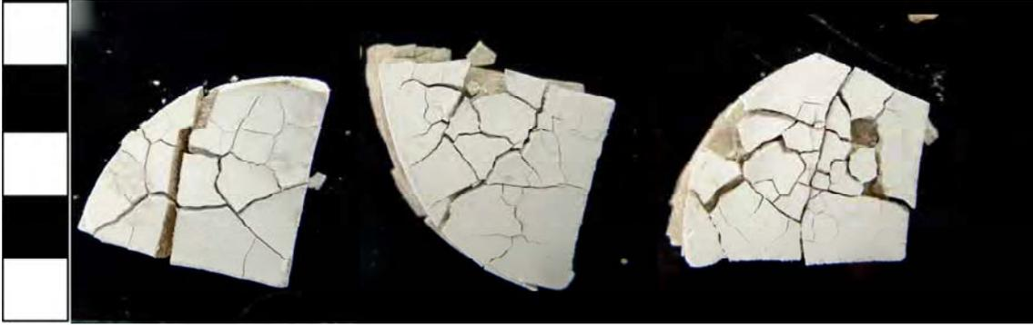
Abb.14: Drei Proben aus einer geviertelten Scheibe des Fuping-County-Limestones nach der Vorbehandlung durch Brennen und Löschen, vor Beginn der Behandlung
