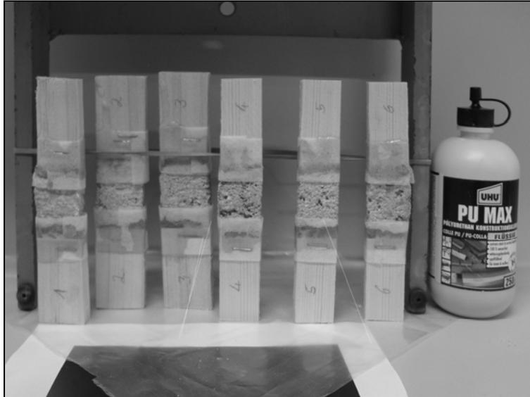
Abb.20: Mit „Prothesen“ (nach DRDÁCKÝ) versehene Proben historischer Mörtel für die Durchführung der Biegezugfestigkeitsprüfung im Dreipunktverfahren
