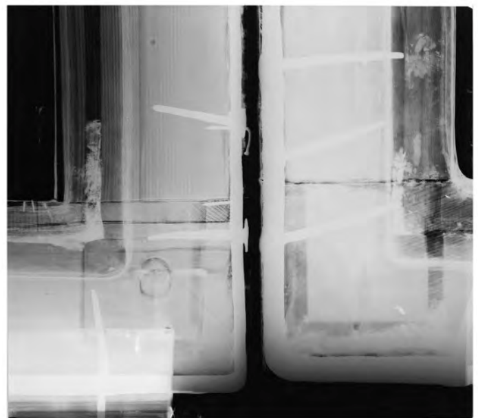
Abb. 41 a,b: Eckverbindungen Mitteltafel und Innenflügel, Röntgenfotos
