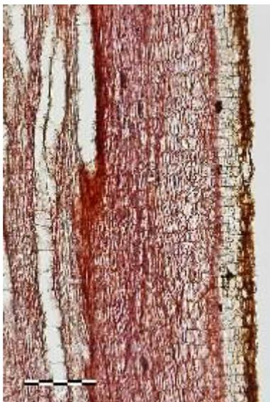
Abb. 19: Tangentialschnitt mit Rinde.
