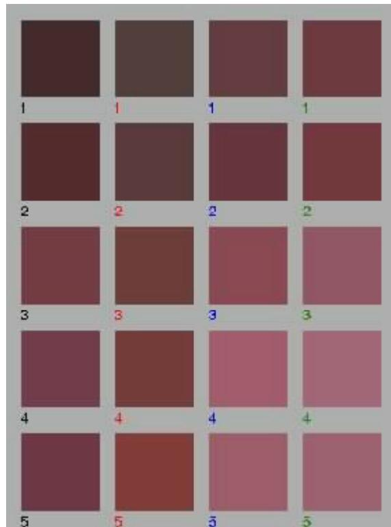
Diagr. 41: L\*a\*b\*-Werte der Pigmente Db V6 bis Db V10 und der daraus hergestellten Aufstriche in unterschiedlichen Bindemitteln.
