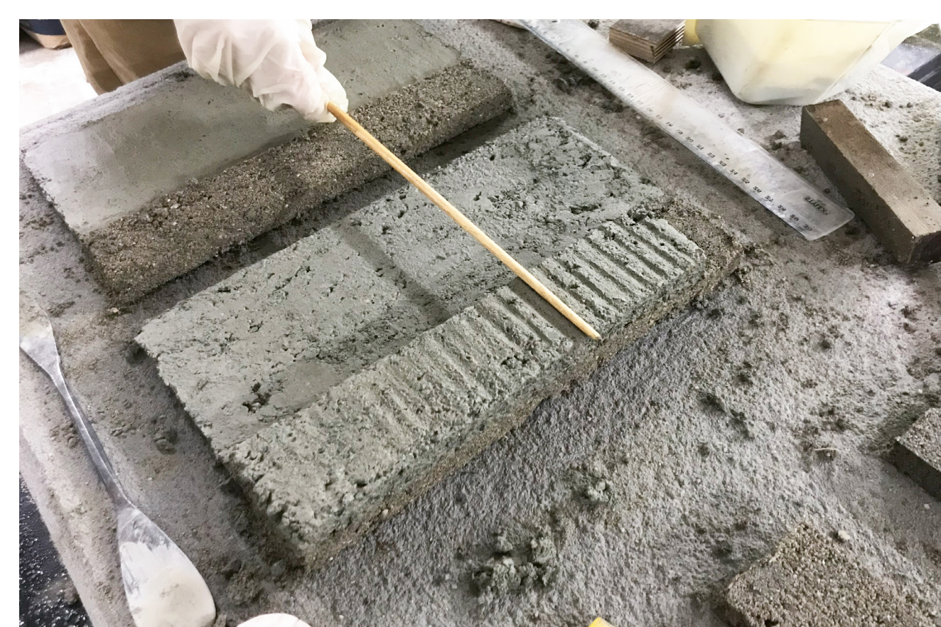
Abb. 7 Testreihe zur Anpassung der Oberflächenstrukturen der Ergänzungsmörtel
