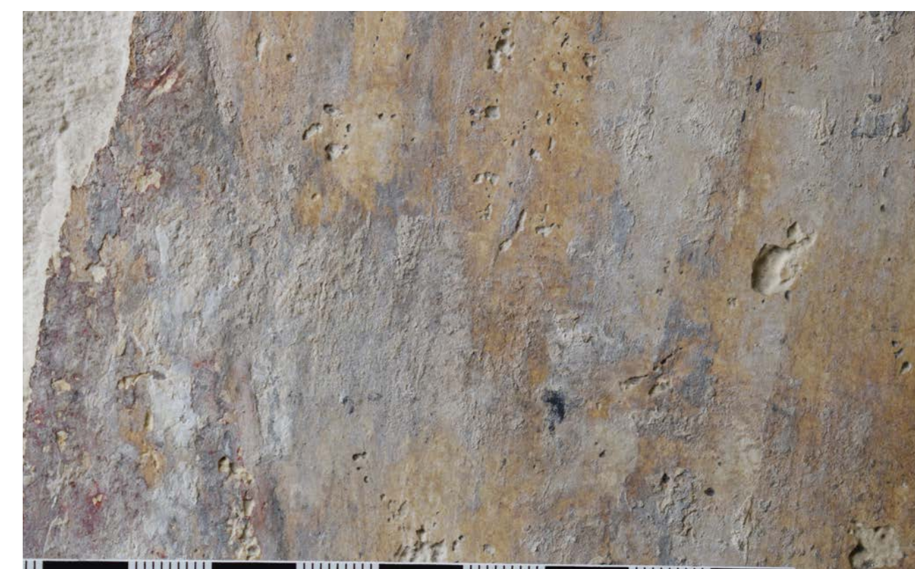
Das Polyester-Urethan hat auf der Maleroberfläche helle Krusten ausgebildet, bei denen es sich wahrscheinlich um ausgeblühte Additive handelt.
