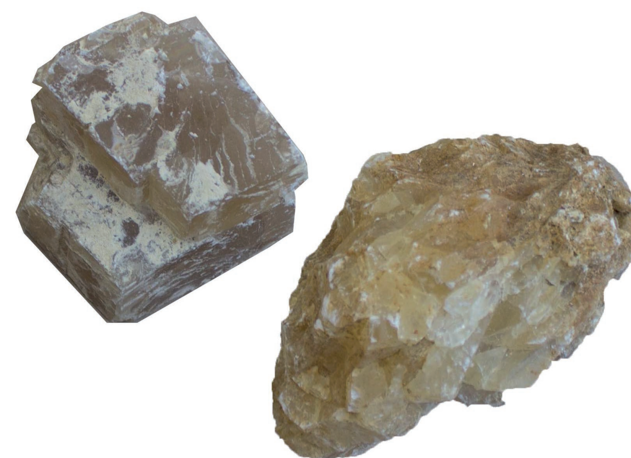
Dies in der Studie als Zuschlag verwendeten Kluftcalcite vor dem Zerkleinern mit einem Backenbrecher
