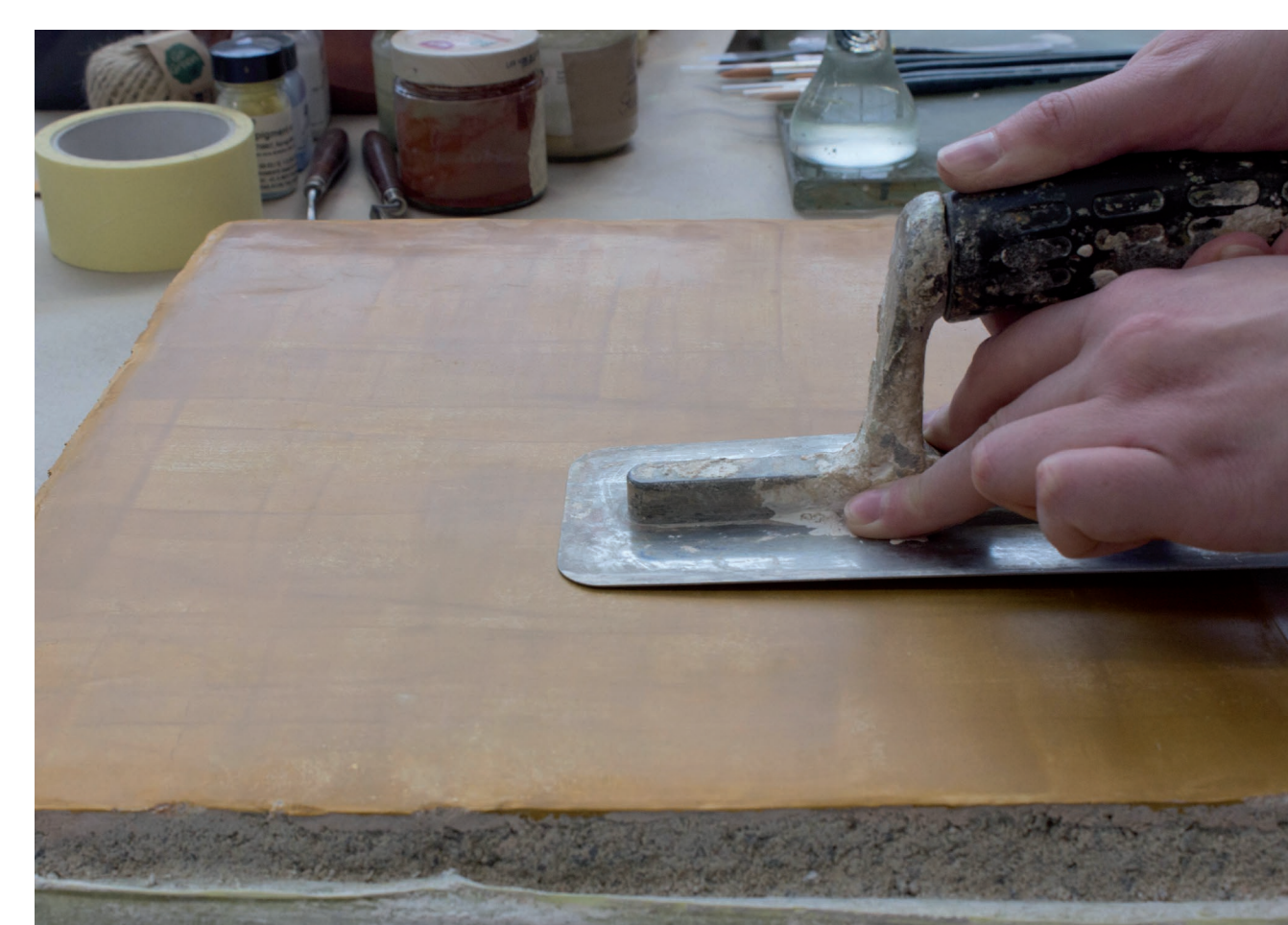
Aufnahme der werktechnischen Studie während des Glättvorgangs der Putzoberfläche mittels Traufel: Im linken oberen Bereich ist bereits der Glanzgrad der Oberfläche zu erkennen
