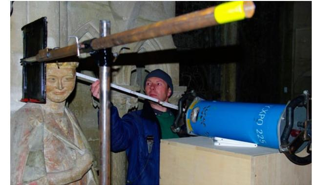
*S. Schaarschmidt (SWS Werkstoffprüfung) bei der Ausrichtung der Röntgenröhre*
